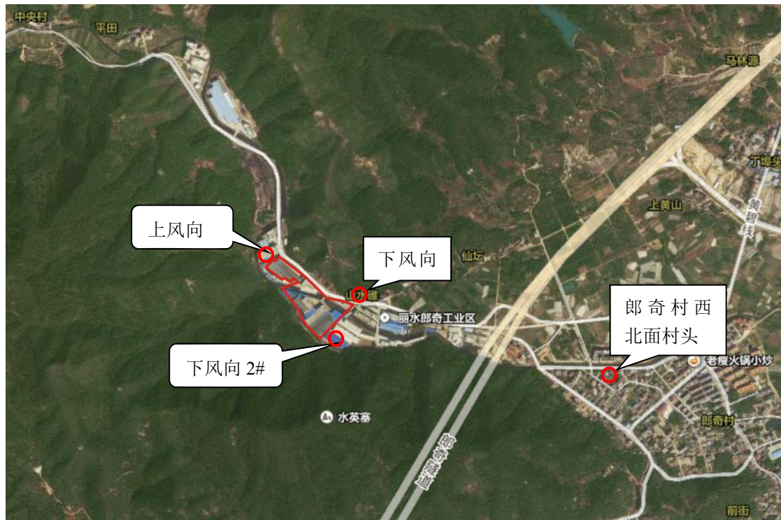
图 2.3-2 无组织废气采样布点示意图
